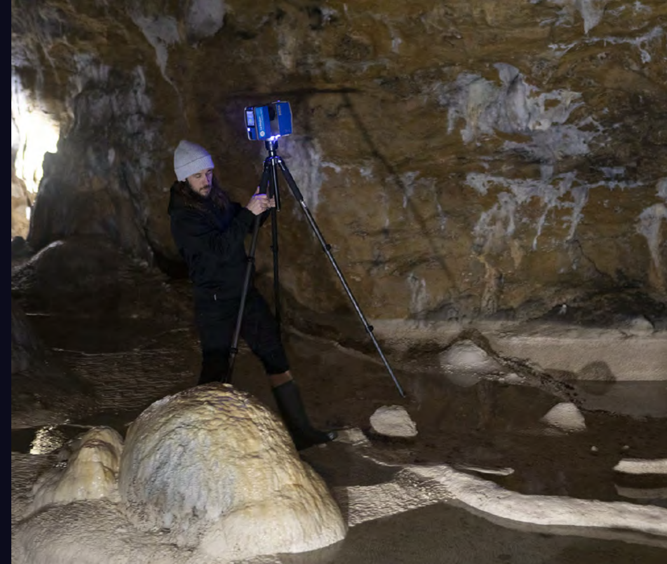
Utilisation du Scan Faro par un technicien de l'INSA, Grotte de la Balme, mars 2022
